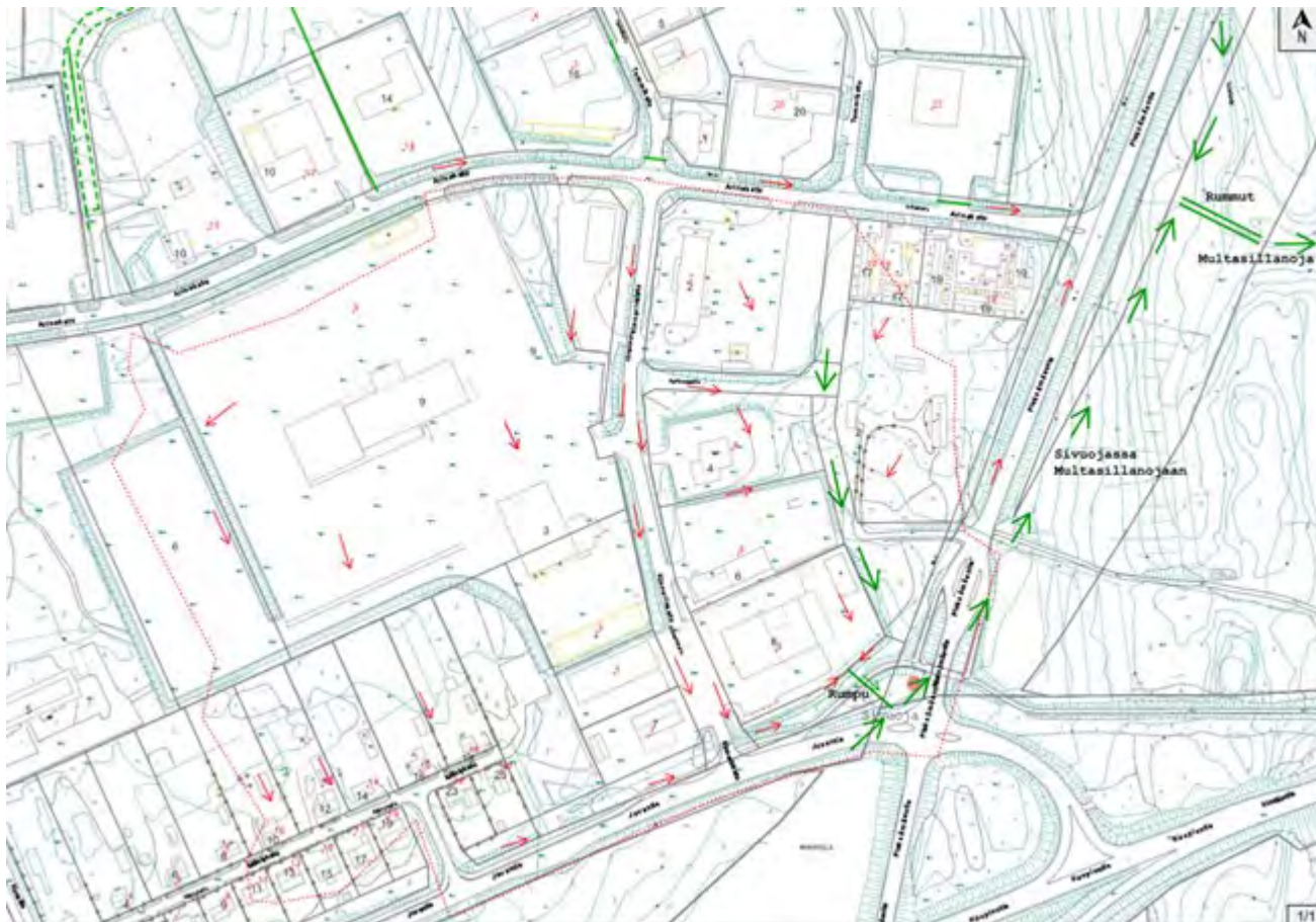
Kuva 2, oleva hulevesiverkosto koostuu avo-ojista, purkusuunnat kuvattu nuolilla.
